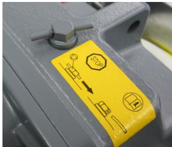
Entlüftung mit Stopfen
